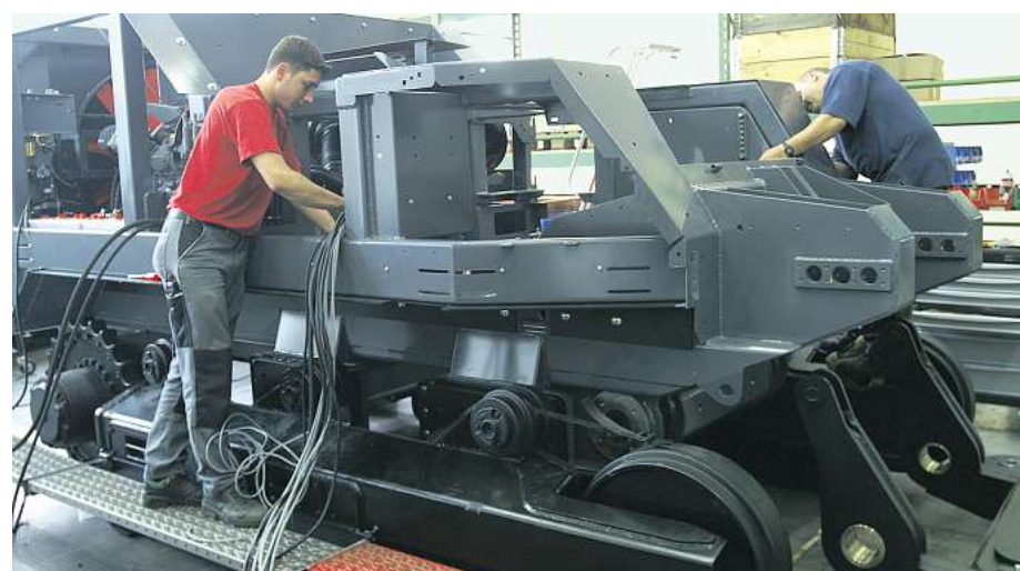
Das Stahlchassis eines MineWolf könnte auch zu einem Panzer gehören. Im Inneren arbeitet ein 400 PS starker V-8-Dieselmotor. Die meisten Teile sind „von der Stange“, stammen also von Baumaschinen- und Nutzfahrzeugherstellern.
