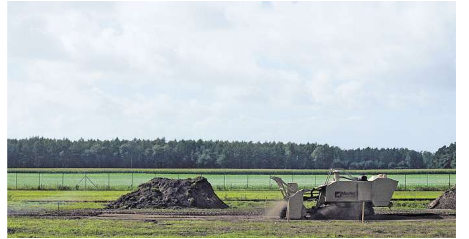
Klein aber zäh: Der Mini-MineWolf fährt ferngesteuert über vermintes Gelände. Erfassen seine tief in den Boden greifenden Krallen eine Mine, verschwindet er vorübergehend in einem Feuerball. Danach setzt das Gefährt seine Räumungsmission unbeirrt fort.
