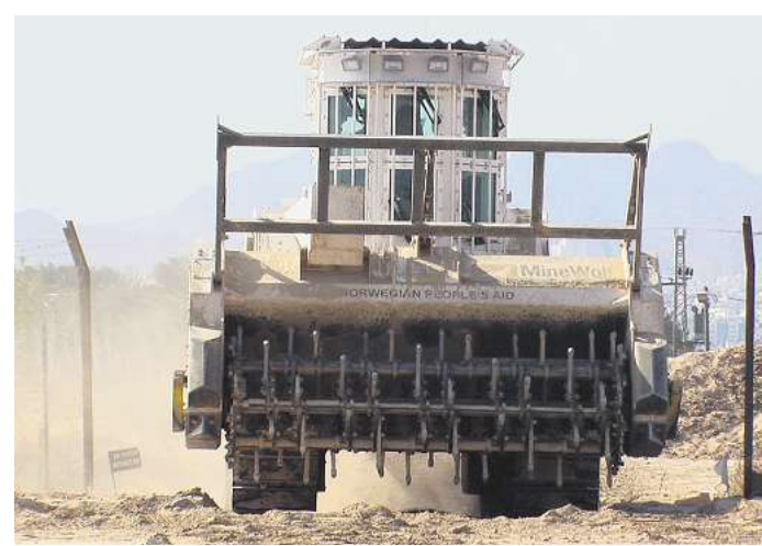
Die Fräse des MineWolf wirkt – gemessen an ihrer Aufgabe – fast filigran. Das ist Absicht. So können die Druckwellen von Explosionen nur wenig Schaden anrichten. Defekte Zähne lassen sich leicht austauschen.
