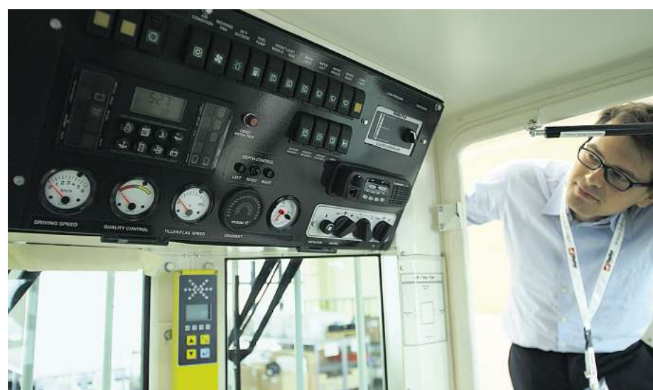
Das gepanzerte Cockpit des MineWolf erinnert an ein Flight Deck. Firmengründer Christoph Frehsee erklärt die Instrumente. Sie helfen dem Fahrer dabei, dass ihm keine Mine entgeht. Gelenkt wird mit Joysticks. Die Kabine ist klimatisiert, einströmende Luft wird gefiltert.
